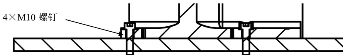
图 2.17 机器人安装举例
