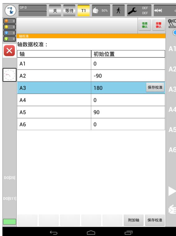
图 3.8 单轴/轴零点校准数据示意图
